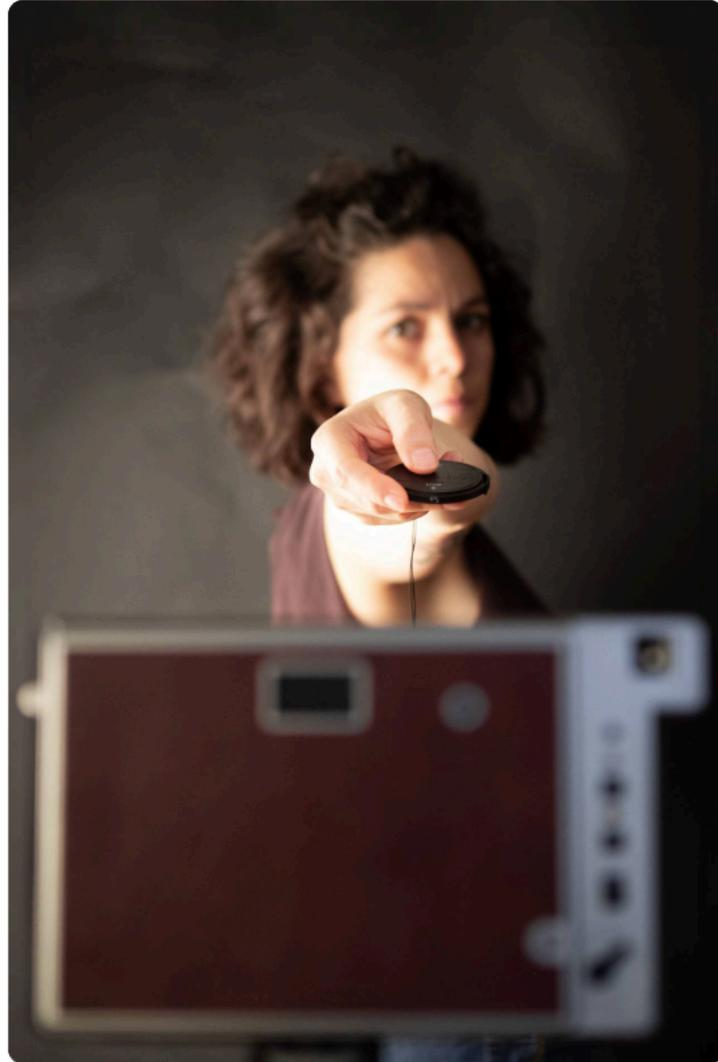
Il tappo di protezione include un Remote Control a infrarossi .Utilizza la pellicola Fuji Instax Wide ( sia colori che in bianco e nero a sviluppo automatico ( occorrono 10 minuti per completare lo sviluppo in luce ambiente, anche se è suggerito tenere l'immagine capovolta durante lo sviluppo ). E' alimentata da quattro batterie stilo AA che sovrintendono anche a un flash incorporato ( disinseribile )
