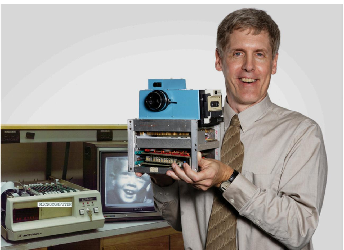
di riprodurre un'immagine ad una risoluzione di 0,01 megapixel e i dati erano registrati in una cassetta. Sasson lavorò sulla tecnologia **CCD** (Charged Coupled Device) che consisteva in un sensore in grado di catturare la luce in due dimensioni, trasformandola in segnale elettrico. Da lì il passo di digitalizzare le immagini, trasformando gli impulsi elettrici in segnale binario, fu breve.
